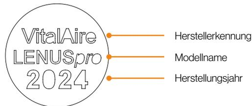
Abbildung 2: Röntgenkennung (schematische Darstellung)
