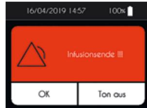
Bei Infusionsende löst die SO\*CONNECT+ erneut ein akustisches Signal und ein rotes Fenster erscheint auf dem Display (siehe linke Abbildung). Während dieses Alarms fährt die SO\*CONNECT+ den Kolben automatisch zurück.
